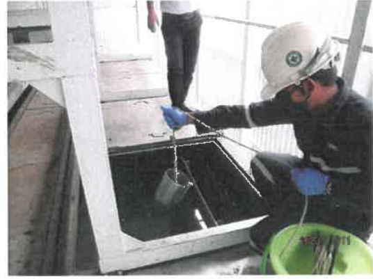
รูปที่ 3-2 การติดตามตรวจสอบ คุณภาพน้ำทั้งหลังการบำบัด บริเวณถังพักน้ำใส (ระบบบำบัด)
