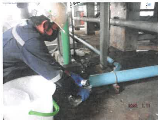
รูปที่ 3-4 การติดตามตรวจสอบคุณภาพน้ำที่ออกหอผึ่งเย็น บริเวณท่อน้ำทิ้งจากหอผึ่งเย็น (Cooling Tower)
